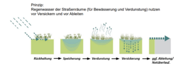
Principe d'évaporation avant infiltration, Blue Green Streets Tool Box A
